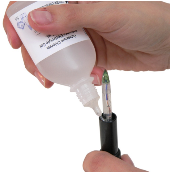
Uzupełnianie elektrolitu żelowego w kołnierzu elektrody
